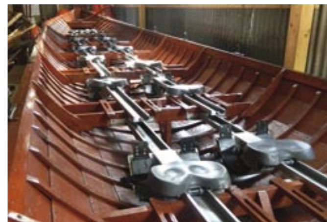
Glidsäten, fasta fotstöd och årtullar ingår i en modern kyrkbåts utrustning. (Foto: Henry Clay Ericsson).
